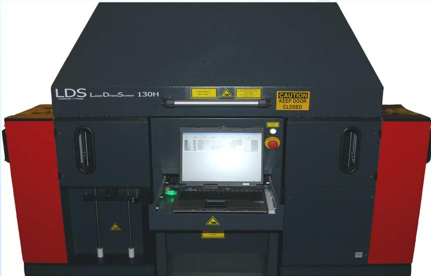
LDS ist ein auf UV- Lasertechnologie basiertes Belichtungs - System für Kleinformate von 130mm bis 380mm Belichtungsbreite bei variabler Länge mit hoher Auflösung.
