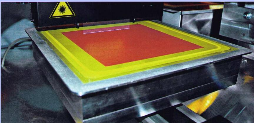
Der UV Laser belichtet das Sieb mit einem runden Punkt, das ergibt deutlich bessere Kanten und Schrägen als mit Rechteckbelichtung.
